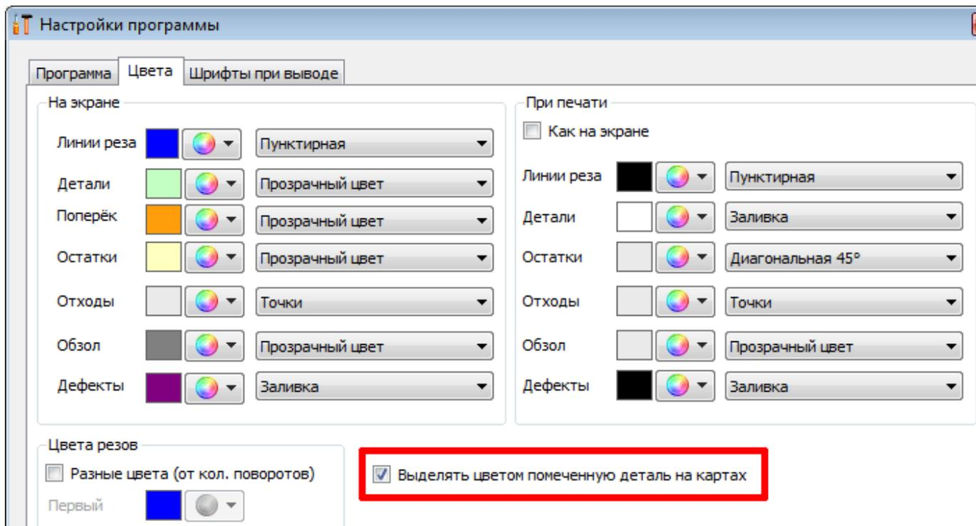
При использовании данной настройки размер и номер детали на всех картах (на экране) выделяется красным цветом:
