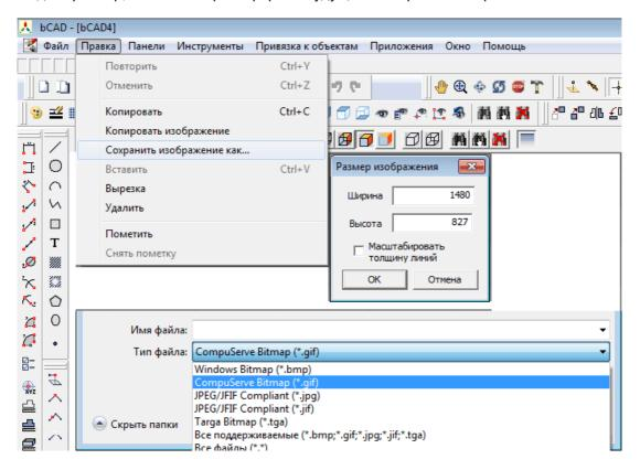
В результате Вы сразу из программного пакета «bCAD Мебель Про» и его модификаций получите растровую картинку с изображением рабочего экрана на текущий момент при любом режиме отображения.
